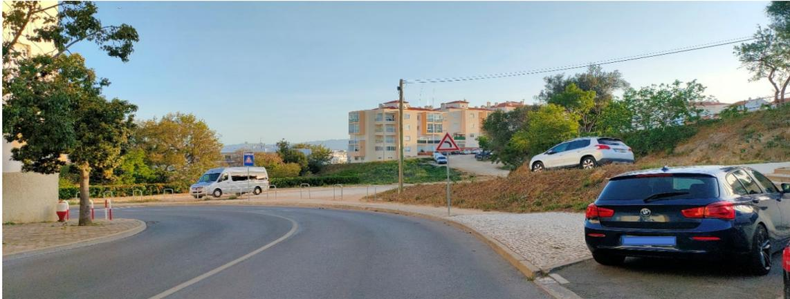
Rua Cabo Bojador - Sinal de perigo colocado na proximidade imediata da própria curva a que se refere. Deveria ser colocado a alguma distância com o respetivo painel adicional de distância.
